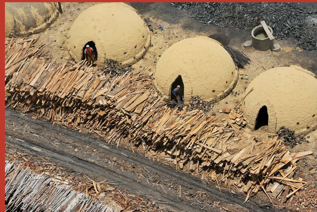
Hornos de producción de carbón vegetal de bosque amazónico para alimentar la industria del acero, Marabá, Pará, Brasil. © Sérgio Vignes, 2011
