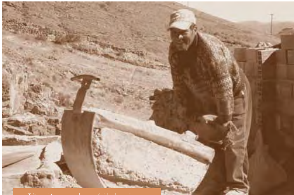
Trituración manual en actividades mineras
